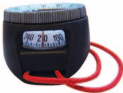
Zaměření buzolou pomocí náměrového okénka.
